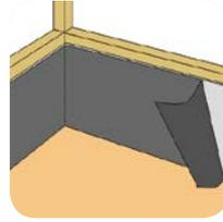
基礎の片面もしくは両面に炭素繊維を貼り付けることにより、地震時の揺れ等で基礎が倒壊することのないようにする基礎の補強工法です。
